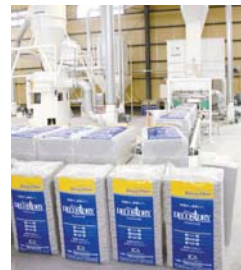
セルロースファイバー断熱材工場
