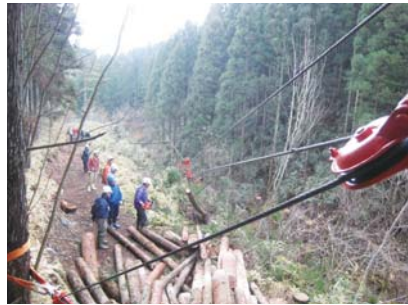
「土佐の森方式軽架線」による木材の搬出
